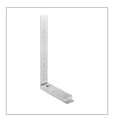
Die HD Zuganker werden zur Verbindung von Holzbauteilen an eine Betonunterkonstruktion verwendet. HD Zuganker bestehen aus zu einem Winkel abgekanteten 2-3 mm dicken, feuerverzinkten Lochblech. Im waagerechten Schenkel sind die Zuganker mit einer Bohrung für Bolzen M12, M16 oder M20 zur **Befestigung auf Beton** versehen. Eine feuerverzinkte Unterlegplatte von 15-20 mm Dicke leitet die Zugkraft aus dem senkrechten Schenkel in die Betonverankerung ein.
