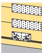
Die BNV Winkelverbinder werden für die Verankerung von Verblockungen in Aussteifungsfeldern eingesetzt, um die Kräfte aus den Verbänden in die Ringbalken oder Deckenplatten einzuleiten. Die Verbinder können auch zum Anschluss von Längskräften bei Wandtafeln eingesetzt werden.
