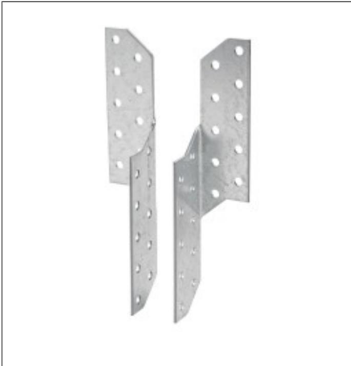
Die SPF Sparrenpfettenanker werden für die Zugverankerung von sich kreuzenden Hölzern verwendet. Ebenso können horizontale Kräfte aufgenommen werden. Belastungsabhängig kommen 2 oder 4 Pfettenanker pro Anschluss zur Anwendung. Bei 2 Pfettenankern pro Anschluss werden 2 linke oder 2 rechte Verbinder benötigt, da diese diagonal gegenüberliegend angeordnet werden sollten, um eine mittige Lasteinleitung zu gewährleisten. Eine Querkzugbeanspruchung der Hölzer ist zu beachten und ggf. nachzuweisen.
