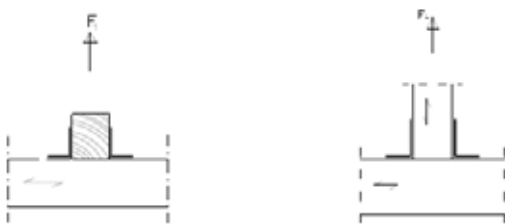
Abb. 1: Belastung durch F_1 , Schwelle und Stütze
