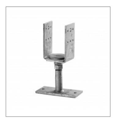
Die höhen- und seitenverstellbaren PVDB Stützenfüße können für alle Holzbreiten zwischen 80-120/ 120-160 mm verwendet werden. Die PVDB werden auf Beton aufgedübelt.
