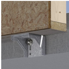
Holzkonstruktion auf dem Konsolwinkel an der Deckenschmalseite.
