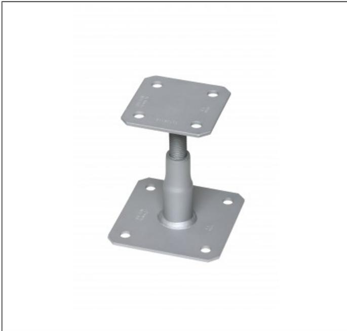
APB100/150Z Stützenfüße sind für Stützen und zur Aufständigung von Wandkonstruktionen bei Holzbreiten ab 100mm Breite geeignet. Eine Höhenverstellung ist im Bereich von 100-150mm möglich.
