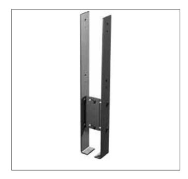
CMR Stützenfüße bestehen aus zwei außenliegenden Stahlteilen, die über ein Mittelstück stufenlos von 120 – 160mm der entsprechenden Stützenbreite angepasst werden können. Sie sind für die Verwendung von Außenbauteilen geeignet.
