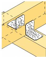
Die ABR Winkelverbinder mit Rippe werden aus feuerverzinktem Stahlblech hergestellt und sind für tragende Holzkonstruktionen geeignet, bei denen große Kräfte übertragen werden müssen.
