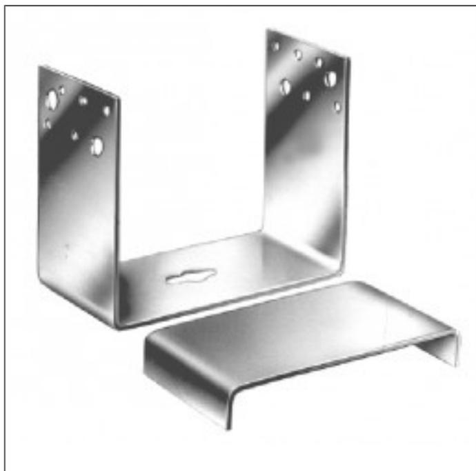
Die PUA Stützenfüße werden direkt auf dem Untergrund aufgestellt und mittels Ankerbolzen befestigt. Die zugehörigen Bodenplatten dienen als Abstandshalter zum Hirnholz der Stütze.
