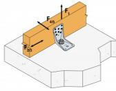
Die AKR Winkelverbinder ermöglichen optimale Anschlüsse zwischen Holz und anderen Baustoffen, wie Beton, Stahl, etc.
