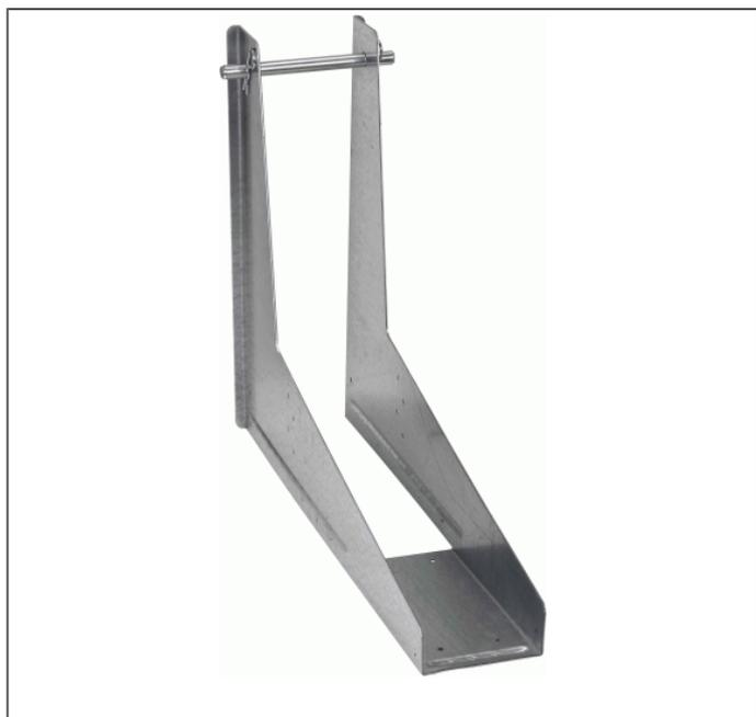
Mit dem Kragarmverbinder „MAXIMUS“ ist es möglich auskragende Konstruktionen jeglicher Art, ohne störende Streben oder Kopfbänder, schnell und effektiv anzuschließen.
