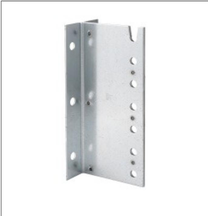
sind für verdeckte Anschlüsse von Holz an Beton konzipiert. Die Anzahl der Stabdübel und Ankerbolzen kann hierbei lastabhängig gewählt werden. BTC Balkenträger sind für Lastaufnahmen in drei Achsrichtungen zugelassen. So lassen sich auch in Dachneigung liegende Balken sicher und einfach anschließen.
