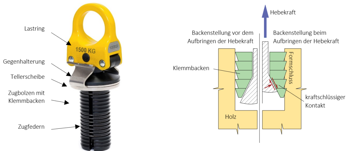
Abbildung 1: Bezeichnung der Komponenten und Wirkungsweise der PowerClamp
