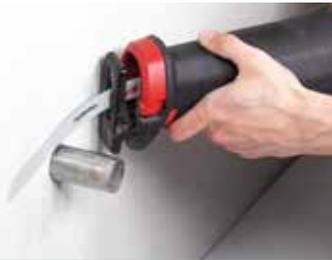
Flächenbündiges Sägen ist mit dem entsprechenden Bimetall-Sägeblatt (BIM) eine leicht zu lösende Aufgabe.
