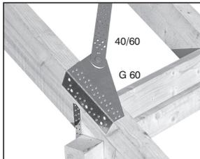
Der Anschluss an der Fußpfette ist hier mit dem Bandanschluss G 60, dem Kopplungsverbinder 40/60 und dem Windrispenband 60 x 2,0 gezeigt.
