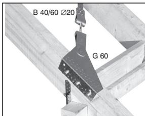
Der Anschluss an der Fußpfette ist hier mit dem Bandanschluss G 60, dem Spanngerät B 40/60 und dem Windrispenband 40 x 2,0 gezeigt.
