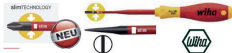
Stückgeprüfte Schutzisolation 1.000 V AC, VDE- und GS-geprüft. Hochwertiger Chrom-Vanadium-Molybdän Stahl, durchgehend gehärtet, brüniert. Direkt auf die Klinge gespritzte Schutzisolation, die im vorderen Bereich vollständig in die Klinge integriert ist. DIN ISO 2380. Gefertigt nach IEC 60900:2004.
