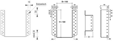
Zur Befestigung des Balkenschuhs BSD an Beton, Stahl und Mauerwerk können werkseitig Löcher bis Ø13mm hergestellt werden.
