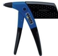
Arbeitsbereich: Setzt Blindniete von 3,0 bis 6,4 mm Ø alle Werkstoffe, außer PolyGrip®-Blindniete und G-Bulb®-Blindniete mit 6,4 mm Ø aus Edelstahl.
