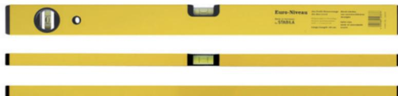
Leichtmetall. Rechteckprofil mit glatten Seitenflächen aus korrosionsbeständiger Leichtmetall-Legierung. Allseitige elektrostatische Pulverbeschichtung in Gelb. Mit unzerbrechlichen Libellen aus Block-Acrylglas. Zur Sicherung der Genauigkeit sind die Libellen in den Wasserwaagenkörper fest eingegossen. Messgenauigkeit in Normallage:  $0,057^\circ = 1,0 \text{ mm/ m}$ .
