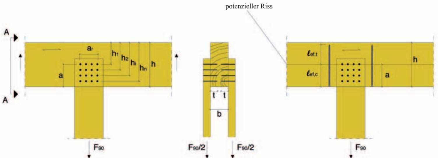
Sofern in den für den Installationsort geltenden nationalen Bestimmungen nicht anders definiert, muss die axiale Tragfähigkeit der Bewehrung eines ausgeklinkten Trägers die folgende Bedingung erfüllen:
