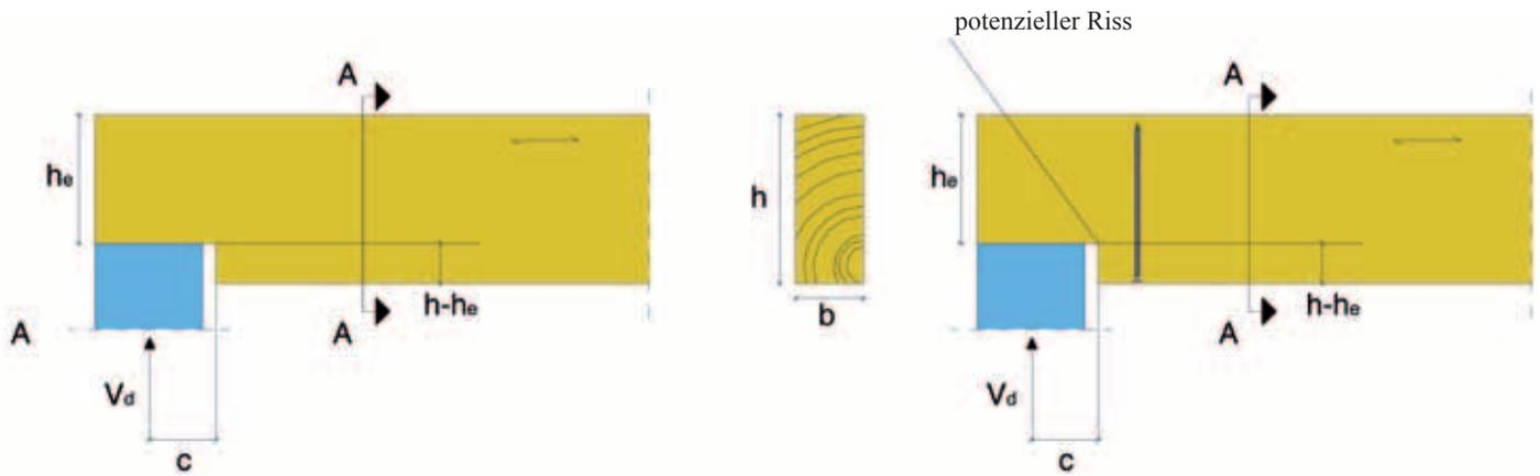
Sofern in den für den Installationsort geltenden nationalen Bestimmungen nicht anders definiert, muss die axiale Tragfähigkeit der Verstärkung eines Durchbruchs die folgende Bedingung erfüllen:
