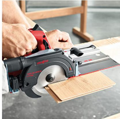
Durch die feste Verbindung der Handkreissäge mit der KSS-Kappschiene ergibt sich eine hochfunktionelle Einhand-Kappschiene-Säge.
