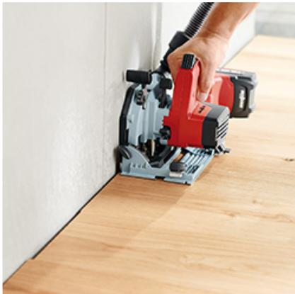
Perfekter Abschluss: Die Abstandhalter der Handkreissäge sorgen dafür, dass exakte Dehnfugen-Schnitte ab 13 mm Breite leicht von der Hand gehen.
