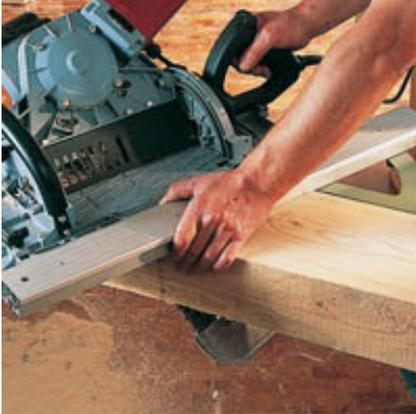
Idealer Einsatzbereich z.B. für Schifterschnitte. Die Universalführung im Sonderzubehör.
