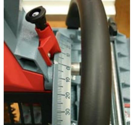
Gut ablesbare Skala. Standard Neigungswinkel können mittels Rastfunktion schnell und einfach eingestellt werden.
