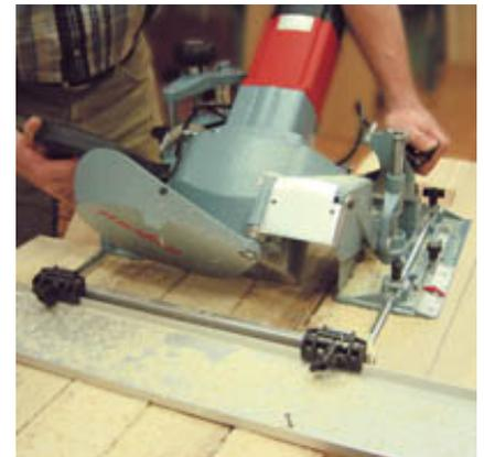
Die ZK 115 Ec mit der Führungsschiene.
