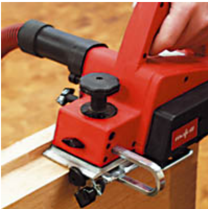
Nachfalzen einer Tür mit dem MHU 82.
