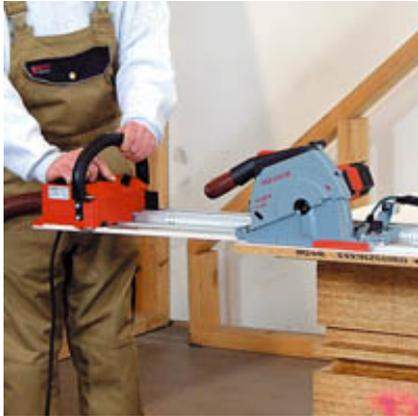
Durch den motorischen Sägevorschub und die Ein-Mann-Bedienung lassen sich Plattenwerkstoffe schnell und einfach bearbeiten.
