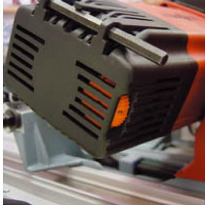
Stellrad zur Einstellung der Drehzahl an verschiedenen Werkstoffe.
