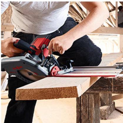
Dank großdimensionierter Winkelskala und präziser Doppelklemmung lassen sich Gehrungsschnitte passgenau umsetzen.
