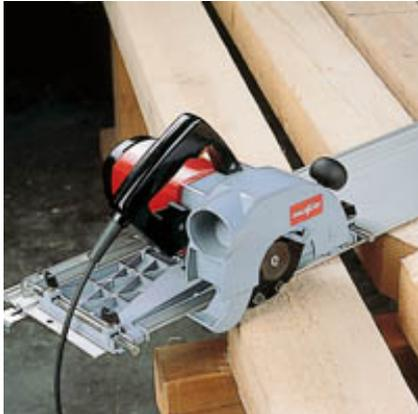
Führungseinrichtung mit Winkelanschlag und Adapter als Sonderzubehör.
