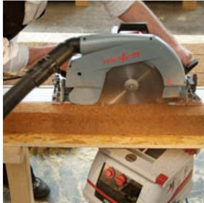
In Kombination mit dem Absauggerät S 50 M und der Führungsschiene sorgt die MKS 130 Ec überall für einen sauberen und genauen Schnitt, auch in problematischen Dämmmaterialien.
