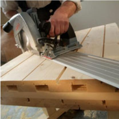
Für präzise Schnitte kann die MKS 130 Ec auf dem Führungsschienen-System F eingesetzt werden.
