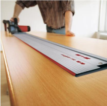
Die KSS 400 kann einfach und schnell von der Systemschiene getrennt und auf eine bestehende Führungsschiene aufgesetzt werden.
