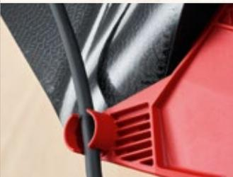
Die Anschlussleitung lässt sich am Gehäuse fixieren. Für ein komfortables und sicheres Arbeiten bei Freiformschnitten und geneigter Sägeeinheit.
