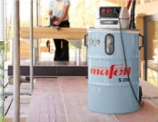
Beim Bearbeiten von Holz-faser-dämmstoffen fallen extreme Mengen von Staub und Spänen an. Der S 200 nimmt bis zu 90% des anfallenden Volumens mühelos auf.
