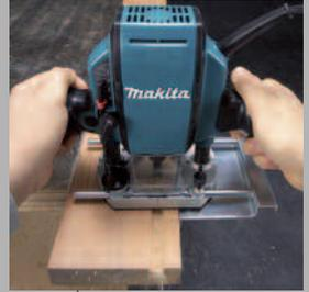
35 mm Frästiefeinstellung mittels Flügelschraube und Revolveranschlag
