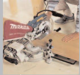
Doppelter Zug-Mechanismus erhöht die Schnittleistung bei kompakter Bauweise. Sehr leichtgängiger Zug-Mechanismus durch 4-fache Lagerung mit Linearkugellagern.
