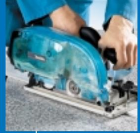
Ohne Fremdabsaugung 94%, mit sogar 98% Staubaufnahme - dabei genauso leistungsfähig wie vergleichbare Handkreissägen
