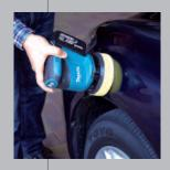
Mit integrierter Absaugung durch die Grundplatte
