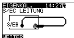
Bild 4.14: Startbildschirm der S/EB-Prüfleitung
