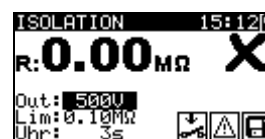
Bild 5.10: Beispiele von Ergebnissen der Isolationswiderstandsmessung
