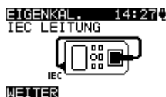
Bild 4.15: Startbildschirm der IEC-Prüfleitung
