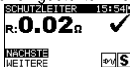
Bild 6.4: VDE-Organisator – Ergebnisbildschirm Schutzleiterwiderstand-Durchgang
