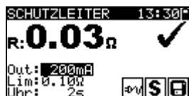
Bild 5.7: Beispiele von Ergebnissen der Schutzleiterwiderstand-Durchgangswiderstandsmessung
