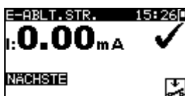
Bild 6.8: VDE-Organisator – Ergebnisbildschirm Ersatzableitstrom
