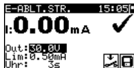
Bild 5.16: Beispiele von Ergebnissen der Messung des Ersatzableitstroms
