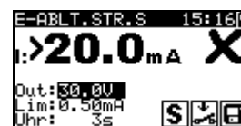
Bild 5.19: Beispiele von Ergebnissen der Messung des Ersatzableitstroms-S
