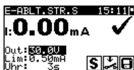
Bild 5.19: Beispiele von Ergebnissen der Messung des Ersatzableitstroms-S
