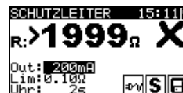
Bild 5.7: Beispiele von Ergebnissen der Schutzleiterwiderstand-Durchgangswiderstandsmessung
