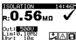
Bild 5.10: Beispiele von Ergebnissen der Isolationswiderstandsmessung
