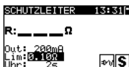
Bild 5.2: Beispiel für ein Einzelprüfungs-Messmenü
