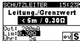
Bild 6.3: VDE-Organisator – Startbildschirm Schutzleiterwiderstand-Durchgang
