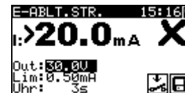
Bild 5.16: Beispiele von Ergebnissen der Messung des Ersatzableitstroms
