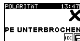
Bild 5.22: Beispiele für Polaritätsprüfungs-Ergebnisse
