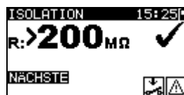
Bild 6.6: VDE-Organisator – Ergebnisbildschirm Isolationswiderstand
