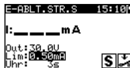
Bild 6.11: VDE-Organisator – Startbildschirm Ersatzableitstrom-S
