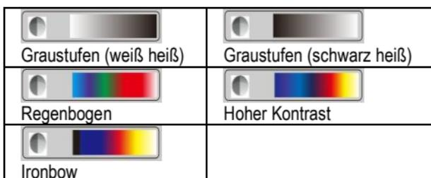
Um die Farbpalette zu ändern, wählen Sie im Hauptmenü die dritte Option „Farbpalette“ an und wechseln Sie mit der Pfeil-Taste „rechts“ in das Untermenü und navigieren Sie nun mit den Pfeil-Tasten „auf“ und „ab“ durch die Optionen. Mit der „SELECT/ENTER“ Taste wird die Auswahl übernommen und mit der „MENU“ Taste wird das Menü wieder verlassen.
