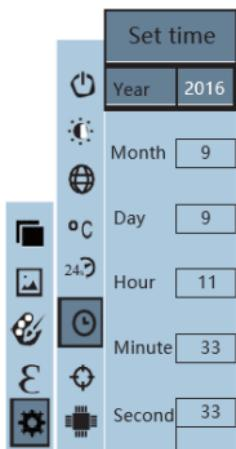
Navegue con las teclas de flecha «arriba» y «abajo» por los posibles campos. Para editar un campo, pulse la tecla «SELECT/ENTER». Con las teclas de flecha «derecha» e «izquierda» puede marcar ahora la cifra deseada, que se puede editar después con las teclas «arriba» y «abajo». Volviendo a pulsar la tecla «SELECT/ENTER» se guarda el ajuste para este campo. Cuando se han finalizado todos los ajustes, se puede volver a salir del submenú con la tecla de flecha «izquierda».
