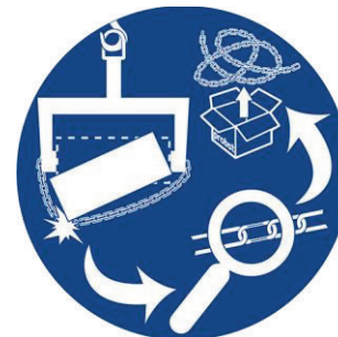
Wenn die Last in die Lastsicherungskette fällt, muss die Kette fachgerecht geprüft und bei Bedarf ersetzt werden. Beschädigte Lastsicherungskette nicht weiter einsetzen!
