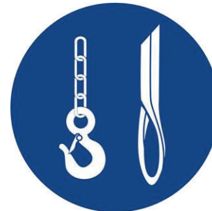
Erlaubte Anschlagmittel: Haken und Lasthebeband.
