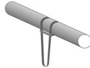
als Ankerstich über einen Träger gelegt und wieder durch das Band zurückgeschlaucht
