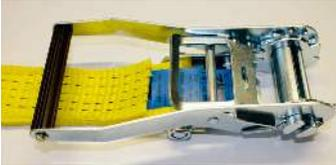
1. Die Ratsche ist vollständig zusammengeklappt und befindet sich in der Sicherungsposition.
