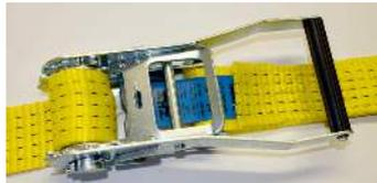
6. Um ein selbstständiges Lösen der Zurrung zu verhindern, muss der Ratschenhebel stets in der Sicherungsposition eingerastet sein. Um diese Position zu erreichen, muss die Sperrklinke erneut gezogen werden.
