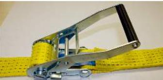
5. Durch Betätigung des Ratschenhebels mit einer Handkraft von ca. 50 daN den Gurt festzurren, um die erforderliche Vorspannkraft zu erreichen.
