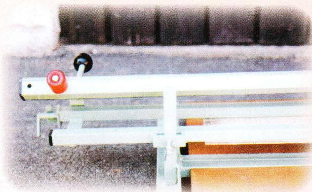
4) Bei Zuschnitten von weichem Material (Klemmfilz usw.) wird das Material beim Zuschneiden gepreßt. Dabei löst man vorne nur die Stellschraube und hebt den Schneidearm nach oben. Durch Drehen nach links eines ein-
