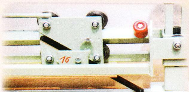
3) Bei Zuschnitten von festen Materialien kann man das Schneidegerät vorne auf die gewünschte Höhe mit einer Flügelschraube fixieren.
